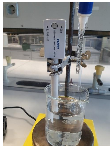
13 a: Układ eksperymentalny do miareczkowania konduktometrycznego 13 b: Elektroda konduktometryczna
