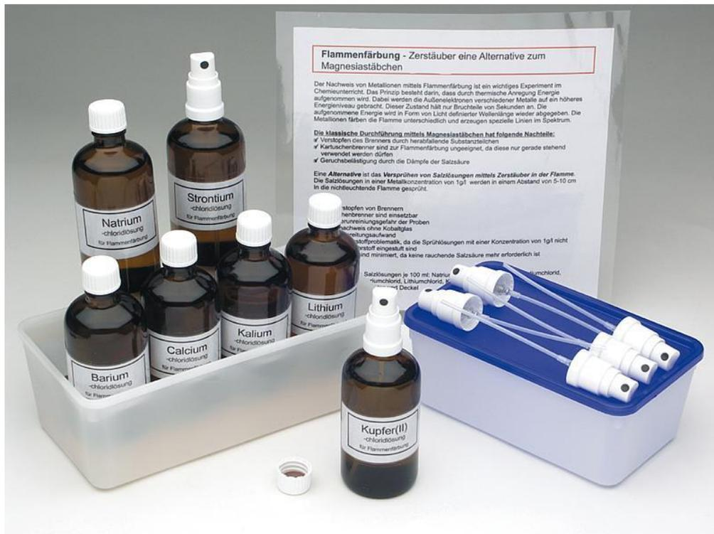
Die Flammenfärbung ist ein zugleich einfacher und eindrucksvoller Nachweis für einige Metalle. Dabei wird eine kleine Probe einer Metallverbindung an einem dünnen Platindraht oder einem kleinen Stäbchen aus Magnesia in die farblose Flamme des Bunsenbrenners gebracht. Insbesondere Alkalimetalle zeigen dann oft eine intensive und charakteristische Färbung der Flamme.
