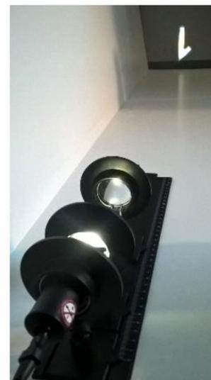
*Die Blende befindet sich im Brennpunkt der Linse. Das Bild entsteht im Unendlichen, unabhängig davon, wie weit man von der Wand entfernt ist.*
