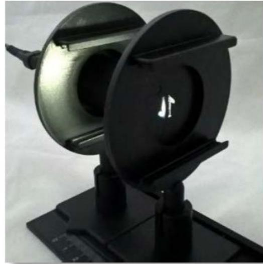
*Die Blende mit der Ziffer „1“ befindet sich im Brennpunkt der Linse. Es ergibt sich ein Bild im Unendlichen. Dank des Spiegels wird das Bild im Unendlichen reflektiert und ein reelles Bild in der Ebene des Objektes selbst erzeugt.*
