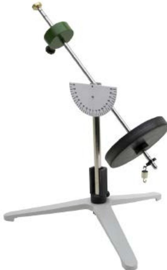
Entfernen Sie nun das Massstück und überprüfen, ob sich das System noch im Gleichgewicht befindet. Ist dies der Fall, schieben Sie die Arretierung wieder nach oben und blockieren diese mit der Rändelschraube.
