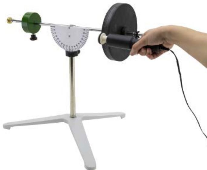
Sie sehen, dass sich jetzt die Tragachse nicht senkt. Statt dessen dreht sich das System mit einer Präzessionsbewegung. Grund ist, dass aufgrund der Masse ein mechanisches Moment  $M$  senkrecht zum Drehimpuls  $\omega$  des Schwungrades wirkt.
