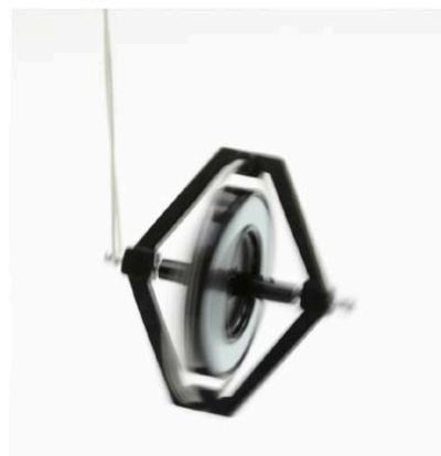
Lassen Sie den Kreisel für eine feste Zeitspanne (z.B.  $t = 20 \text{ s}$ ) drehen und zählen die Anzahl der Präzessionsdrehungen. Es gilt folgende Gleichung:
