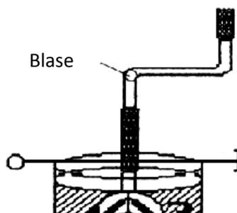
Öfter genügt die günstige Lage des Acrylglasrohres, damit alle freigesetzten Gasblasen in das Bogenrohr gelangen.
