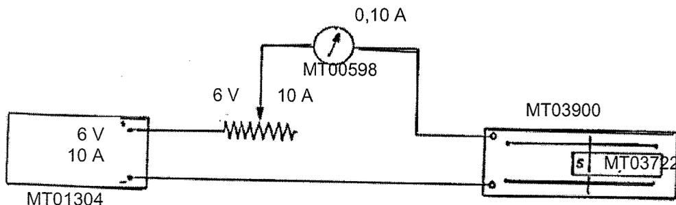
Achten Sie ganz besonders darauf, daß die Kontakte zwischen dem mobilen Element und den Schienen absolut sauber sind. Das Magnetfeld wird durch einen kräftigen Dauermagneten erzeugt. Das äußere Feld ist weitaus wichtiger als das Erdmagnetfeld. Das Erdmagnetfeld hat keinerlei Auswirkung auf die Montage.
