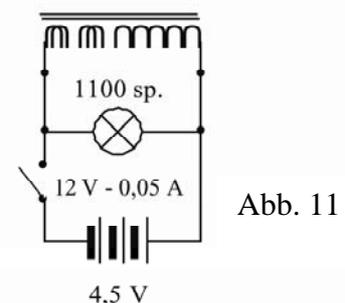
zeigen, indem man den Versuch mit der el. Schaltung nach Abb.11 durchführt. Schließt man den Stromkreis, so fließt der Strom durch Glühbirne und Spule. Der Kreis wird mit einer Spannung von 4.5 V versorgt, die Glühbirne ist jedoch für 12 V ausgelegt und so glüht sie nur ganz schwach. Beim Auftrennen des Kreises leuchtet die Glühbirne für einen kurzen Moment hell auf.
