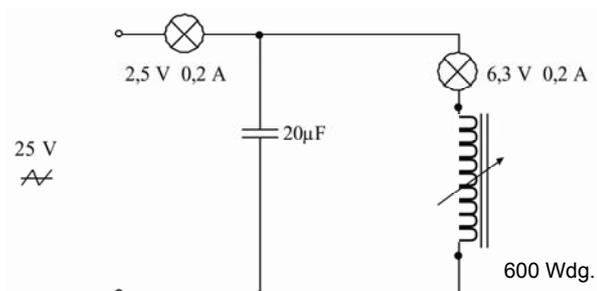
geschaltete Glühbirne (1). Bei Resonanz erlischt die Glühbirne in Reihe und die Glühbirne (2) des Resonanzschwingkreises beginnt zu brennen. Die Glühbirne (1) brennt nicht, weil in diesem Moment der Versorgungsstrom sehr schwach ist. Der Strom hingegen im Parallelkreis ist sehr stark und somit brennt die Glühbirne (2). Das ist die Resonanz der Ströme.
