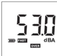
Wenn der Schallpegel über dem eingestellten Wert erkannt wird, gibt das Gerät je nach Einstellung ein akustisches und visuelles Signal (LED blinkt) aus.
